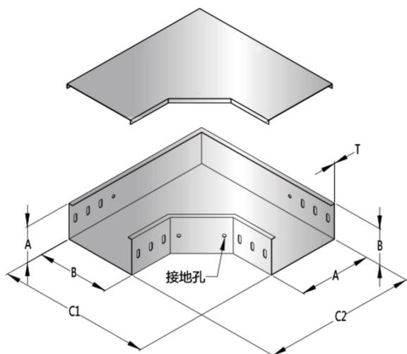
槽式桥架水平弯通
